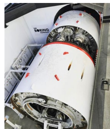
Godot – die erste Generation der Tunnelbohrmaschinen Fotos: The Boring Company
