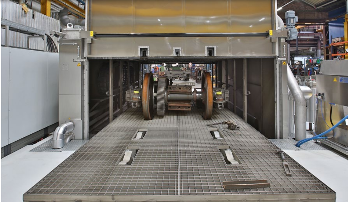
Effiziente Reinigung von Radsätzen und Drehgestellen mit der Reinigungsanlage Pacific.
