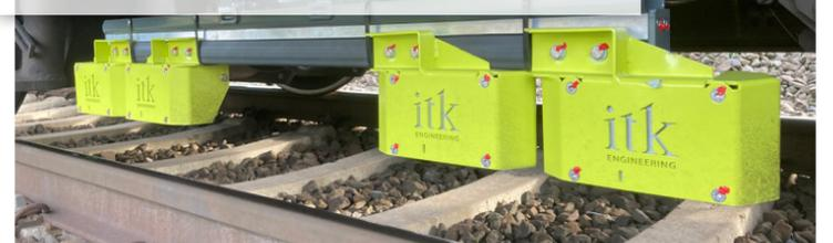
Positionsbestimmung durch Veränderung des elektromagnetischen Feldes. Foto: ITK Engineering
